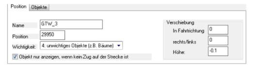
Anschließend muss der GTW im Fenster "Objekte" nach folgendem Muster zusammengesetzt werden:
